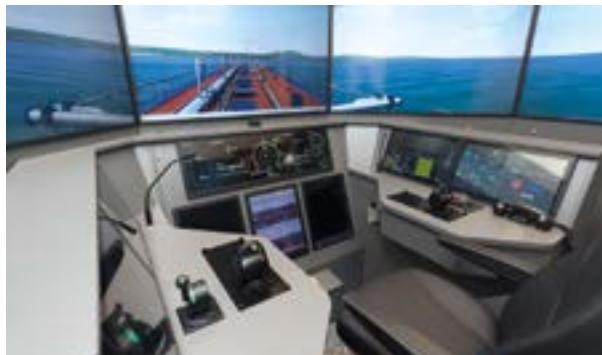
Kernelemente sind dabei ein oder mehrere Steuerstände, die mit den auf Binnenschiffen üblichen und gängigen Anzeigen und Bedienelementen ausgerüstet sind und von denen aus Schiffe vermeintlich aktiv gefahren werden können.
